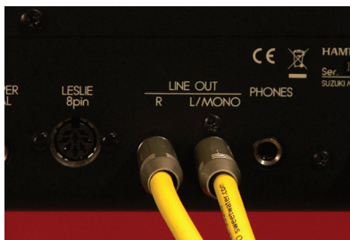
CÂBLES 1/4 DE POUCE À L'ARRIÈRE DE SK
