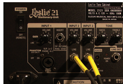
CÂBLES 1/4 DE POUCE À L'ARRIÈRE DE LESLIE 2121
